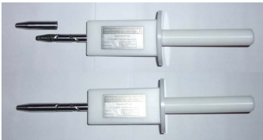
Bild 14: Mögliche Anpassung des Prüffingers bei größeren Gehäuseöffnungen
