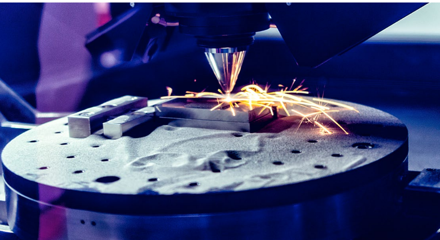
Una stampante 3D produce un componente dalla polvere di metallo
