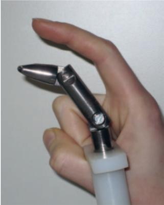
**Possibile adattamento del dito di prova per aperture più grandi negli involucri**
