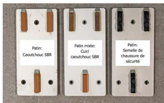
Appareil de mesure du glissement GMG 200 et patins équipés de différents matériaux de semelles de chaussures
