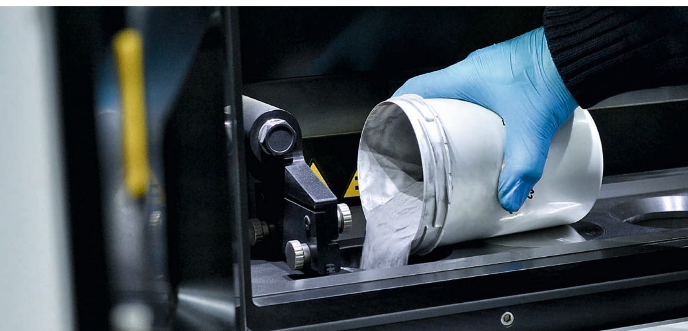
De la poudre métallique sert de matériau de départ pour la fabrication additive.
