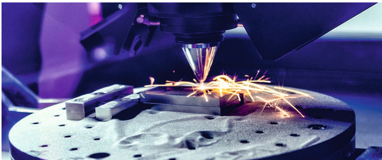
Imprimante 3D produisant une pièce à partir de poudre métallique.
