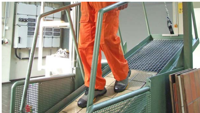
Person geht auf einer schiefen Ebene zur Prüfung der Rutschhemmung des Bodenbelags
