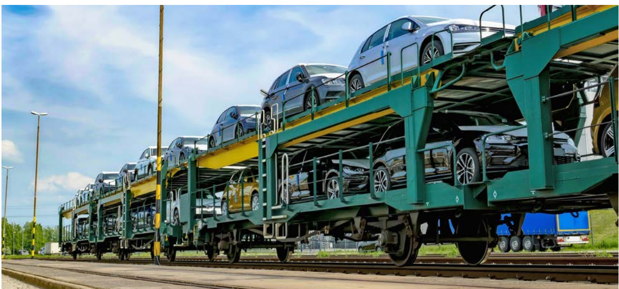
Offener Autotransportwagen mit zwei Ladeebenen und Geländerhöhe 60 cm
