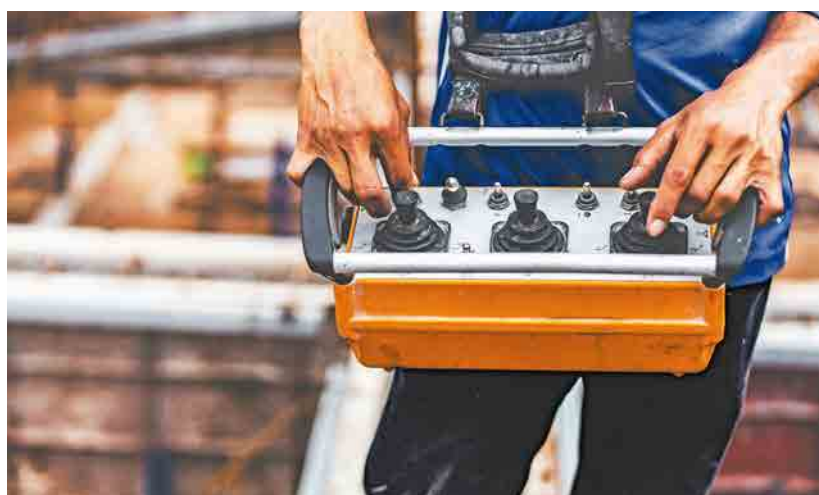
Les commandes radio sont sujettes aux failles de sécurité informatique.
