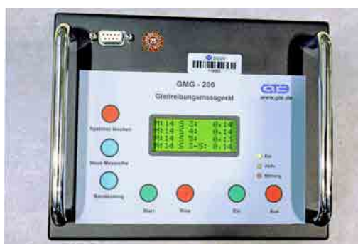
Appareil de mesure du glissement GMG 200 et patins équipés de différents matériaux de semelles de chaussures
