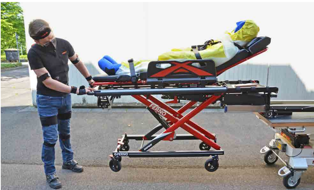
Das Fahrgestell einer elektrohydraulischen Fahrtrage wird auf Knopfdruck vor dem Einladen eingefahren.
