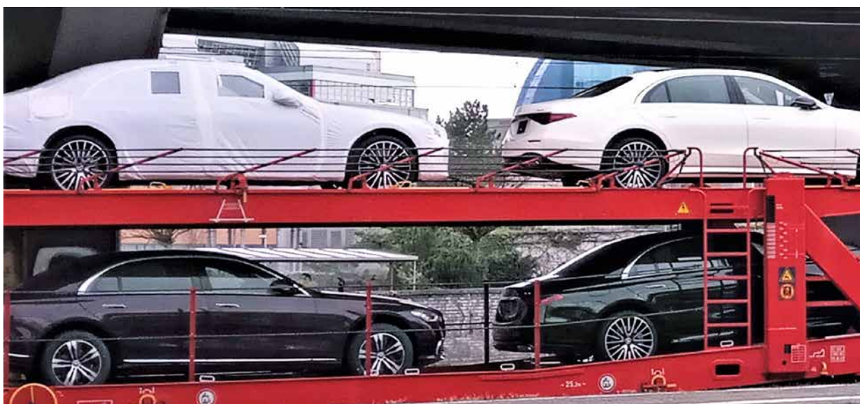
Wagon porte-automobiles avec un garde-corps rabattu pendant le déplacement du train
