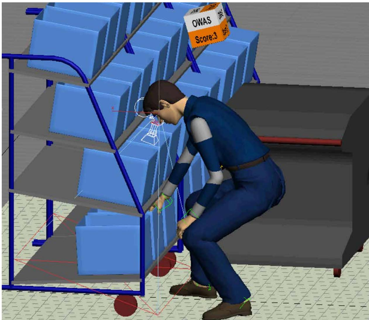
L'analyse OWAS met en évidence la nécessité d'adapter le poste de travail.
