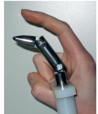
Prüffinger nach DIN EN 60529
