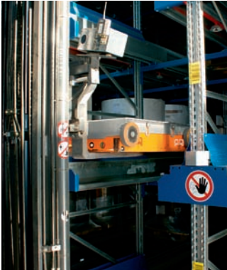
Einsetzen eines Satellitenfahrzeuges in einen Kanal mittels Schubmaststapler
