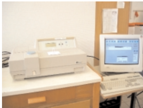
UV/VIS-Spektrometer: Nachweis von Chromat nach DIN
