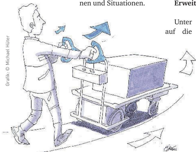
Das Steuerungssystem touch2move der Firma Espresso verfügt über zwei Handgriffe mit integrierten Kraftsensoren für verschiedene Antriebe und kann in unterschiedlichsten Wagen eingesetzt werden.
