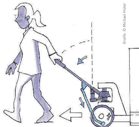
Die Anfahrhilfe BT Pro Lifter für Gabelhubwagen verwendet das Hebelprinzip der Kraftübertragung, indem es die Bewegung der Deichsel über einen zuschaltbaren Mechanismus direkt auf die Räder überträgt.
