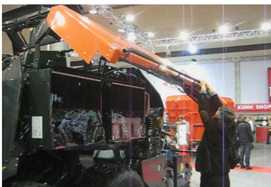
Fig. 21: Side flap on a big baler (Kuhn LSB 1270)
