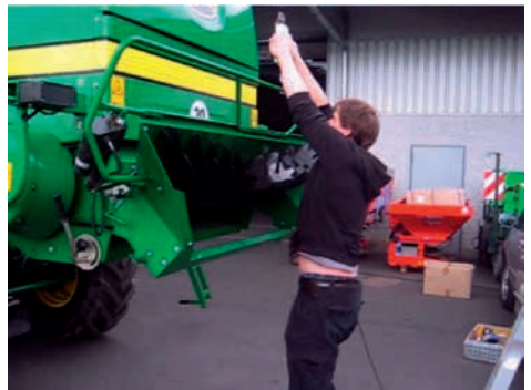
Abb. 103: Anheben des Häckslers an einem Mähdrescher (John Deere T560). Zugmessung mit handgehaltenem Kraftmessgerät, Kraftschluss mit Schlauchschelle, Versuchsperson 2.
