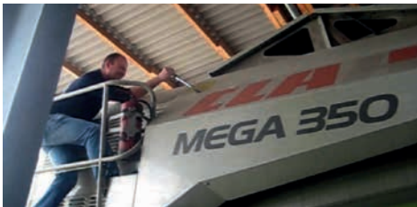
Abb. 12: Korntank-Öffnung an einem Mähdrescher (Claas Mega 350), die Öffnung des Tanks erfolgt über eine halbe Drehung.
