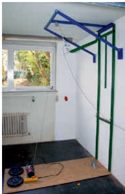
Abb. 7: Montage des in Abb. 6 beschriebenen Kraftmesssystems am Messstand mit zusätzlicher automatischer Geschwindigkeitsregelung durch eine Winde.
