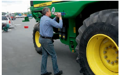
Abb. 97 und Abb. 98: Schließen der rechten Seitenklappe an einem Mährescher (John Deere T560), Druckmessung mit handgehaltenem Kraftmessgerät, Kraftschluss über oberflächenschonende Kunststoffmatte, Versuchsperson 4.
