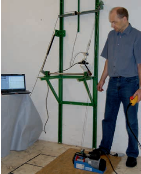
Abb. 56: Betätigung eines Hebels. Messstand mit Winde (automatische Geschwindigkeit, Zugsensor und Winkelmessung).
