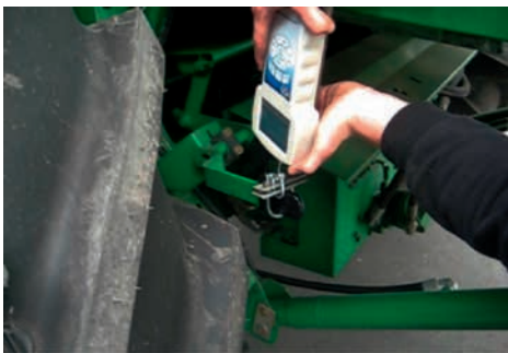
Abb. 82 und Abb. 83: Hebel am Schrägförderer an einem Mähdrescher (John Deere T560). Zugmessung mit handgehaltenem Kraftmessgerät, Kraftschluss mit Schlauchschelle, Versuchsperson 2.
