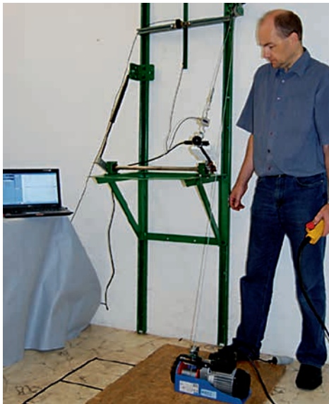
Abb. 133: Betätigung eines Hebels. Messstand mit Winde (automatische Geschwindigkeit, Zugsensor und Winkelmessung).
