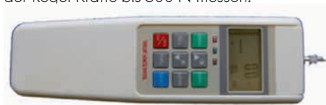
Abb. 4: Beispiel für ein handgehaltenes elektronisches Kraftmessgerät: Sauter FH 10. Speicherung von Kraft-Zeit-Verläufen nicht möglich.
