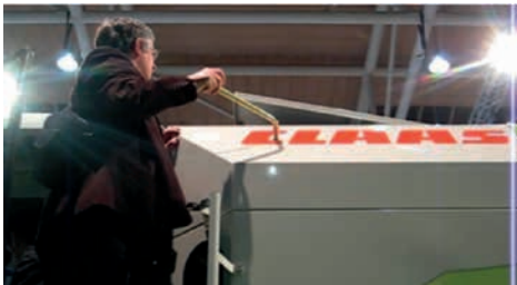
Abb. 11: Korntank-Öffnung an einem Mähdrescher (Claas Avero), die Öffnung des Tanks erfolgt über eine ganze Drehung.
