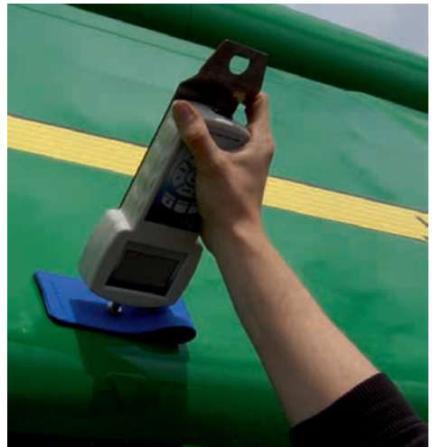
Abb. 52: Schutz gegen Lackschäden bei der Messung durch eine Gummimatte.
