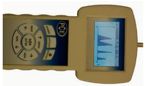
Abb. 5: Beispiel für ein handgehaltenes elektronisches Kraftmessgerät: PCE-FG 500. Speicherung von Kraft-Zeit-Verläufen möglich.
