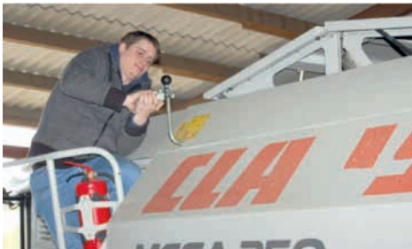
Abb. 54: Korntank-Öffnung an einem Mährescher (Claas Mega 350), die Öffnung des Tanks erfolgt über eine halbe Drehung. Messung mit handgehaltenes Kraftmessgerät. Abb. 53: Versuchsperson 1, Abb. 54: Versuchsperson 2.
