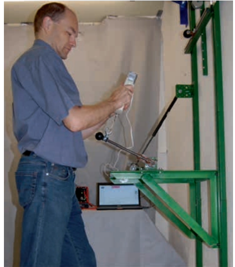
Abb. 57: Betätigung eines Hebels. Versuchsperson 5 mit handgehaltenem Kraftmessgerät. Das Messgerät wird im 90-Grad-Winkel zum Hebel geführt.
