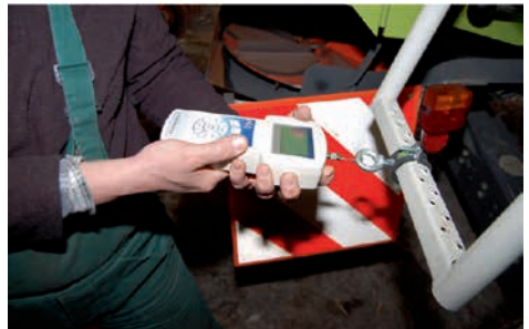
Abb. 118 und Abb. 119: Ziehen der Aufstiegsleiter zum Korntank aus der Arretierung, Mähdrescher (Claas Mega 350). Messung mit handgehaltenem Kraftmessgerät, Fixierung des Kraft-Ansetzpunktes mit Schlauchschelle, Versuchsperson 3.
