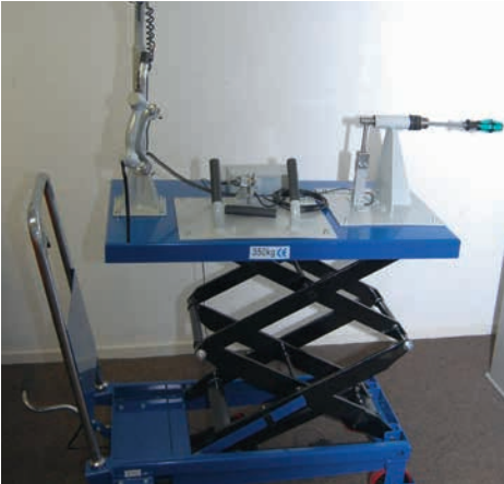
Abb. 59: Mobiler Kraftmessstand des Instituts ASER e.V. für die Feldforschung. Durchführbar sind Messungen von Handdruckkräften, Zugkräften und Torsionskräften. Die Montage auf dem Scherenhubtisch ermöglicht die Messung in standardisierten Körperhaltungen.
