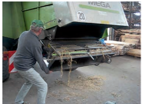
Abb. 25: Manuelle Häcksler-Verstellung an einem Mähdrescher (Claas Mega 350). Bei kleineren Mähdreschern ist diese manuelle Häcksler-Verstellung öfter anzutreffen.
