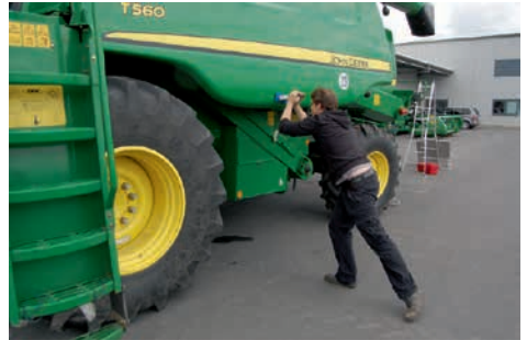
Abb. 92 und Abb. 93: Schließen der linken Seitenklappe an einem Mähdrescher (John Deere T560), Druckmessung mit handgehaltenem Kraftmessgerät, Kraftschluss über oberflächenschonende Kunststoffmatte, Versuchsperson 2.
