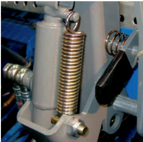
Abb. 75: Hebel mit zu kurzem Griff und somit eingeschränkter Kraftübertragung.
