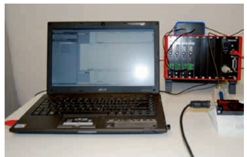
Abb. 44: Kraftmesssystem auf Basis der Next-View-Software mit bmcM-Messverstärker.
