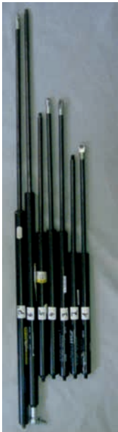
Abb. 138: Für die Laborversuche eingesetzte Gasdruckfedern mit unterschiedlichen Längen und Drücken.
