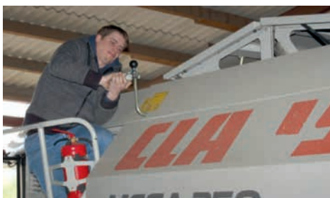
Abb. 76 und Abb. 77: Korntank-Öffnung an einem Mähdre- scher (Claas Mega 350), die Öffnung des Tanks erfolgt über eine halbe Dre- hung. Messung mit handgehaltenem Kraftmessgerät. Oben: Versuchsperson 1, unten: Versuchsperson 2.
