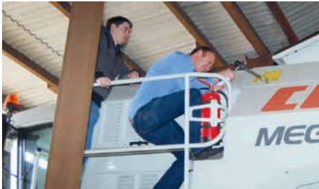
Abb. 53: Korntank-Öffnung an einem Mährescher (Claas Mega 350), die Öffnung des Tanks erfolgt über eine halbe Drehung. Messung mit handgehaltenes Kraftmessgerät. Abb. 53: Versuchsperson 1, Abb. 54: Versuchsperson 2.
