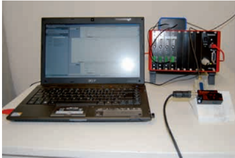
Abb. 6: Kraftmesssystem auf Basis der NextView Software mit bmcM Messverstärker, Zug-/Drucksensor von ME-Systeme und Neigungsensor von Kübler.
