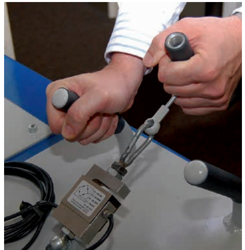
Abb. 61: Messung der Zugkraft.
