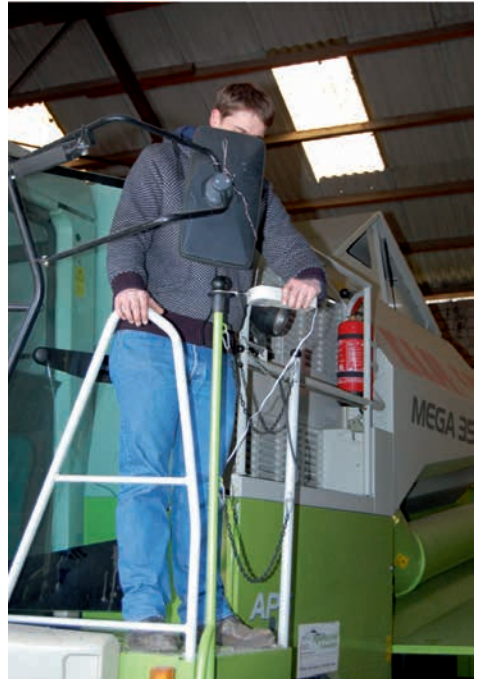
Abb. 127 und Abb. 128: Aufstieg zum Führerhaus aus- und eindreihen, Mähdrescher (Claas Mega 350). Messung mit handgehaltenem Kraftmessgerät, Kraft-Ansatzpunkt mit Seil, Versuchsperson 2.
