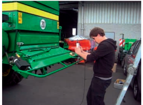
Abb. 102: Anheben des Häckslers an einem Mähdrescher (John Deere T560). Zugmessung mit handgehaltenem Kraftmessgerät, Kraftschluss mit Schlauchschelle, Versuchsperson 2.
