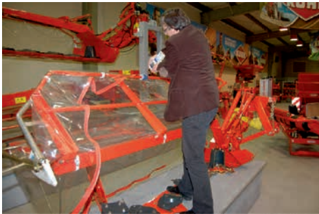
Abb. 105 und Abb. 106: Anheben und Schließen der Abdeckung an einem Scheibenmäher (Kuhn GMD 600 GII), Zugmessung mit handgehaltenem Kraftmessgerät, Kraftschluss mit Schlauchschelle, Versuchsperson 3. Die Abdeckplane ist zu Anschauungszwecken transparent ausgeführt.
