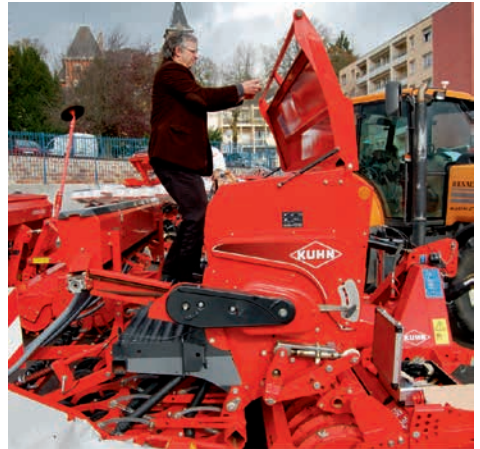
Abb. 112: Schließen der Saatgutklappe an einer Drillmaschine (Kuhn Integra). Zugmessung mit handgehaltenem Kraftmessgerät, Kraftschluss mit Schlauchschelle, Versuchsperson 5 (links) und Versuchsperson 3 (rechts).
