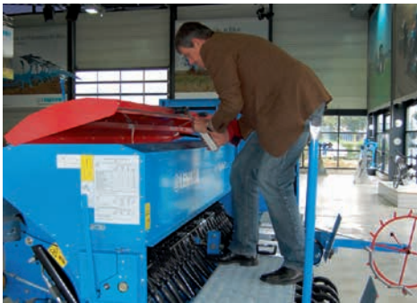
Abb. 108 und Abb. 109: Schließen der Saatgutklappe an einer Drillmaschine (Lemken Saphir 7). Zugmessung mit handgehaltenem Kraftmessgerät, Kraftschluss mit Schlauchschelle, Versuchsperson 3 (oben) und Versuchsperson 4 (unten).
