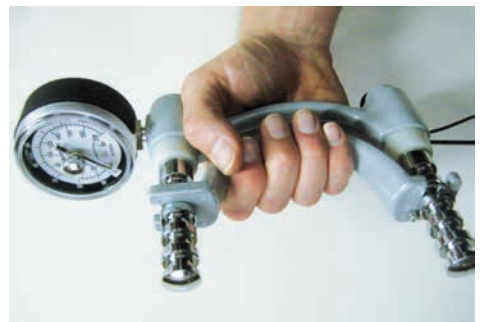
Abb. 3: Beispiel für ein mechanisches Kraftmessgerät: Jamar-Dynamometer (Manometerprinzip).
