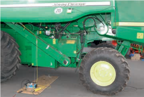
Abb. 95: Schließen der linken Seitenklappe an einem Mährescher (John Deere T560), Zugmessung mit komplexem Verfahren.
