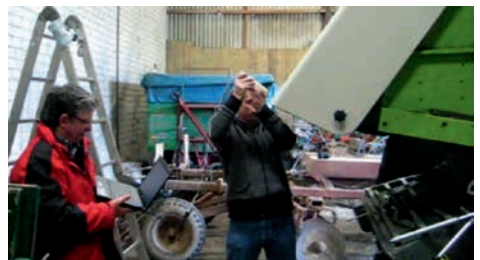
Abb. 85 und Abb. 86: Öffnen der Heckklappe an einem Mähdrescher (Claas Mega 350), Messung mit handgehaltenem Kraftmessgerät, Versuchsperson 2.
