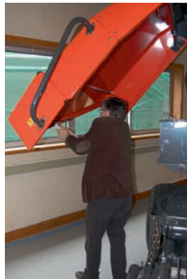
Abb. 89 und Abb. 90: Schließen der Seitenklappe an einer Rundballenpresse (Kuhn VB 2190), Zugmessung mit handgehaltenem Kraftmessgerät, Kraftschluss über Zughaken an einer Metallverstrebung, Versuchsperson 3. Ab einem Ausstellwinkel von ca. 30^\circ ist die Kraft der Gasdruckdämpfer überwunden und die Klappe fällt selbstständig in die Arretierung.
