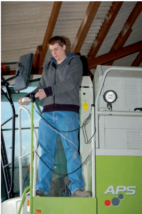
Abb. 127 und Abb. 128: Aufstieg zum Führerhaus aus- und eindreihen, Mähdrescher (Claas Mega 350). Messung mit handgehaltenem Kraftmessgerät, Kraft-Ansatzpunkt mit Seil, Versuchsperson 2.
