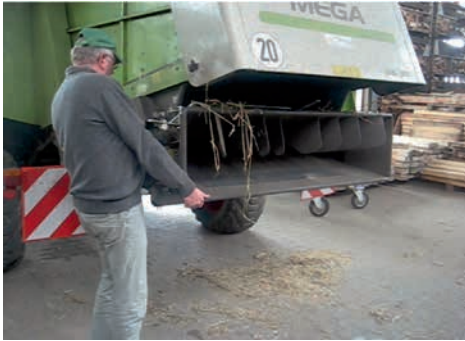
Abb. 26: Manuelle Häcksler-Verstellung an einem Mähdrescher (Claas Mega 350). Der Häcksler wird mit einer Hand gehoben und mit der anderen arretiert.
