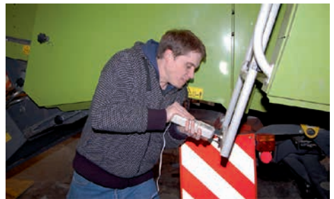
Abb. 115: Messung mit handgehaltenem Kraftmessgerät, Fixierung des Kraft-Ansatzpunktes mit Magnet, Versuchsperson 2.
