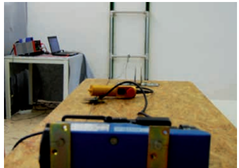
Abb. 154: Lösen einer arretierten Leiter. Messstand mit Winde.
