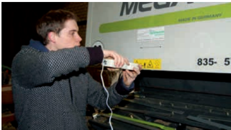
Abb. 85 und Abb. 86: Öffnen der Heckklappe an einem Mähdrescher (Claas Mega 350), Messung mit handgehaltenem Kraftmessgerät, Versuchsperson 2.
