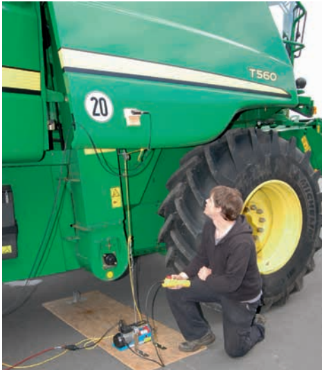
Abb. 100: Schließen der linken Seitenklappe an einem Mähdrescher (John Deere T560), Zugmessung mit komplexem Verfahren.
