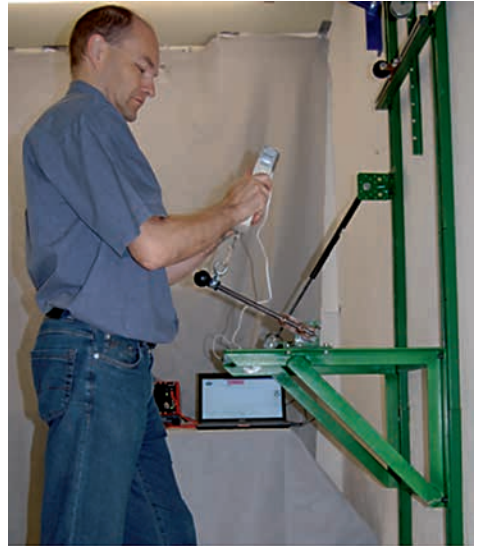
Abb. 134: Betätigung eines Hebels. Versuchsperson 5 mit handgehaltenem Kraftmessgerät. Das Messgerät wird im 90 ° Winkel zum Hebel geführt.
