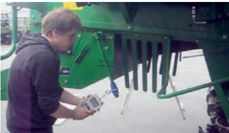
Abb. 79 und Abb. 80: Hebel zur Häckslverstellung an einem Mähdrescher (John Deere T560). Zugmessung mit handgehaltenem Kraftmessgerät, Kraftschluss mit Schlauchschelle, Versuchsperson 2.
