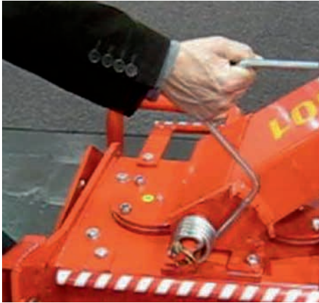
Abb. 74: Hebel mit zu dünnem Griff und somit eingeschränkter Kraftübertragung.
