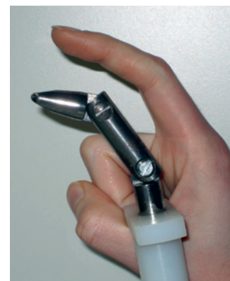
Doigt d'essai selon DIN EN 60529
