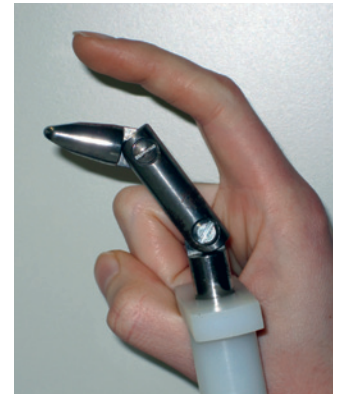
Prüffinger nach DIN EN 60529
